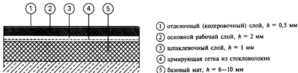
Схема 3. Пол с синтетическим покрытием заливного типа
